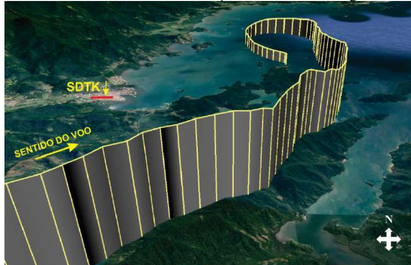
Figura - Reconstituição do perfil da descida da aeronave, conforme os dados do RADAR de controle de tráfego aéreo.
